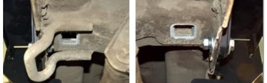
**ШАГ 3.** Установите закладные пластины гайками M12x1,25 вверх в квадратные технологические отверстия. С помощью дрели или шуруповорта со сверлом на 16мм расширьте круглые технологические отверстия во внутренних стенках боковых лонжеронов.
