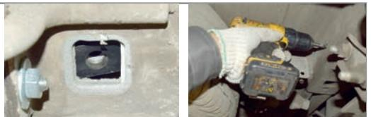
**ШАГ 4.** Установите боковые кронштейны закрепив их в закладных с помощью болтов M12x1,25x60 через дистанционные пластины - по две с каждой стороны. Задние части кронштейнов зафиксируйте болтами M12x130 с надетыми на них шайбами и втулками продев их сквозь лонжерон и закрепив гайками M12 через шайбы и гроверы на 12.
