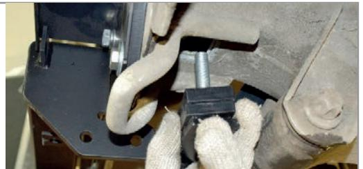
**ШАГ 5.** Соедините кронштейны боковые и центральный с помощью болтов M12x1,25x40 с шайбами на 12 с двух сторон и гроверами с гайками M12x1,25.
